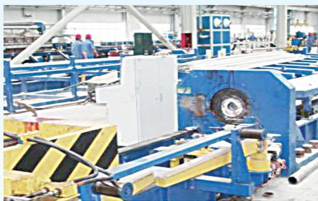
**【事故经过】**某单位1名职工利用拉拔机自动运行间隙,对工模具进行打磨作业中,被自动运行的拉拔机挤在模具间,经抢救无效死亡。
