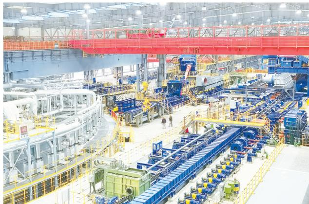
近日,在用户现场所有人的注视下,只见烧红的管坯出自加热炉后,依次实现穿孔、连轧、减径、冷却、精整……整个过程一气呵成,所有人欢呼雀跃。经最终检验,产品完全符合精度要求,也标志着公司制造的Φ258mm连轧管机组顺利实现全线贯通。
